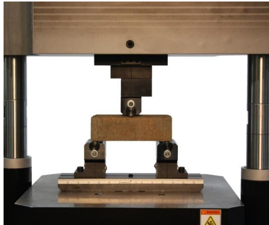
รูปที่ 4 แสดงการทดสอบหาความแข็งแรงต่อแรงดัดโดยใช้แรงกด 3 จุด
